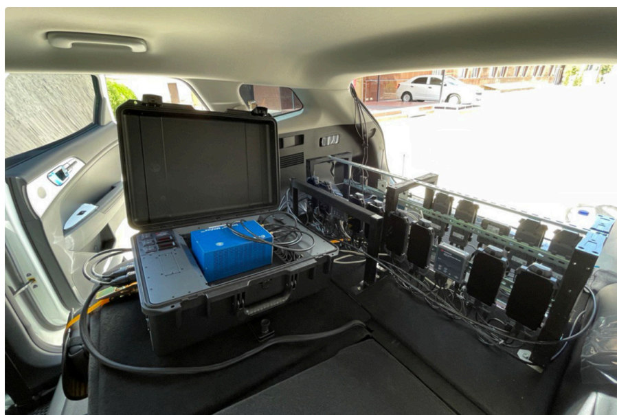
Рисунок 8. Измерительный комплекс, установленный в автомобиле
