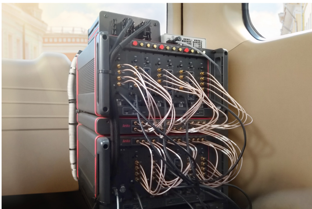
Рисунок 7. Измерительный комплекс, установленный в автомобиле
