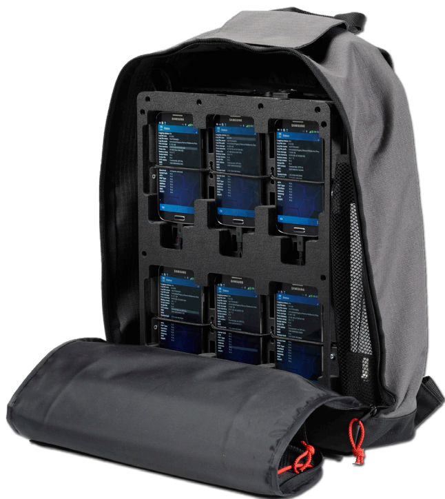
Рисунок 8. Измерительный комплекс Nemo Walker Air
