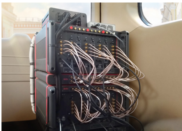
Рисунок 10. Измерительный комплекс Nemo Invex II, установленный в автомобиле.
