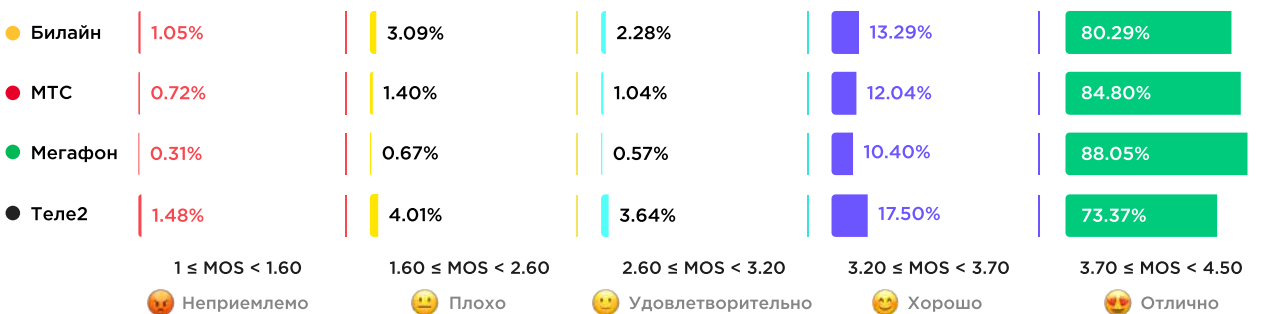
Рисунок 4. Распределение градаций качества принимаемой речи
